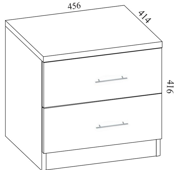
Габаритные размеры: длина - 456 мм, высота - 416 мм, глубина - 414 мм.
