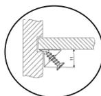
Схема крепления держателя задней стенки
